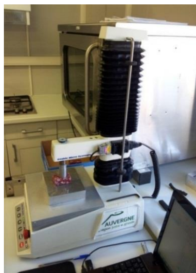
Figure 2.5 Photographie montrant le dispositif expérimental de mesure par « texture profile analysis » (TPA) de la texture des échantillons de saucissons secs.
