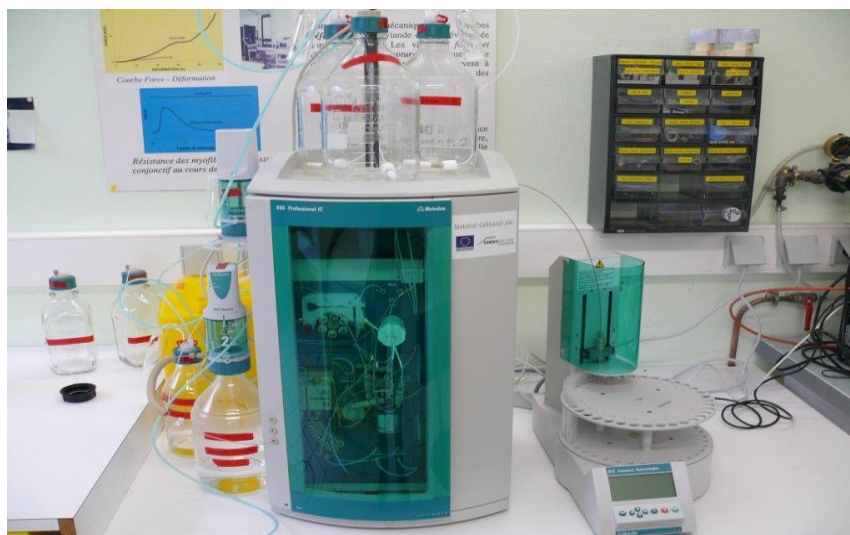
Figure 2.2 Photographie montrant l'appareil de chromatographie ionique du laboratoire utilisé pour le dosage des ions chlorure, sodium ou potassium.
