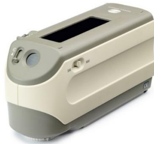
Figure 2.7 Photographie montrant le spectrophotomètre du laboratoire utilisé pour mesurer la couleur des échantillons de saucissons secs.
